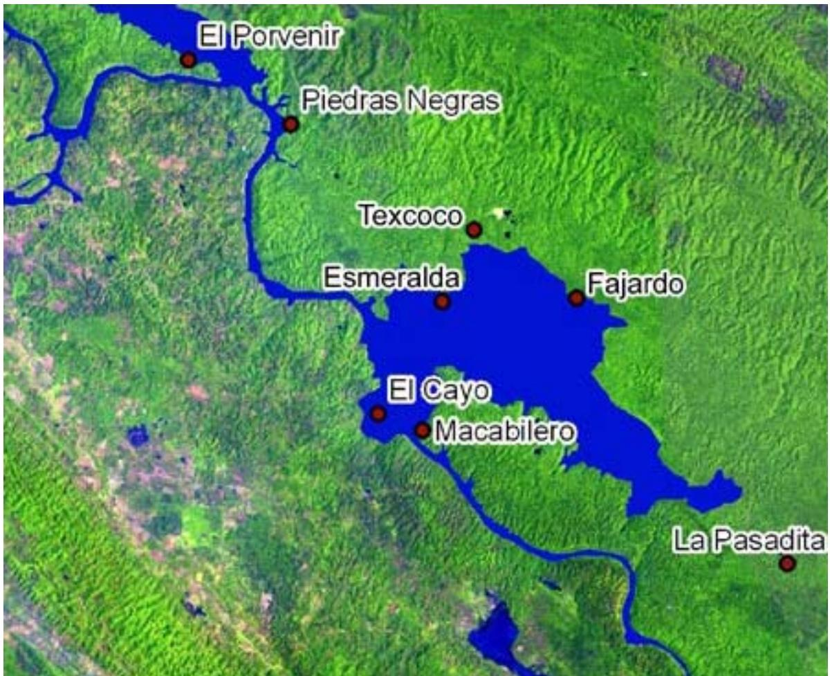
Figura 2. Maqueta en la que se observa el impacto de la inundación resultante de una represa de 46 m en la Boca del Cerro, Tabasco (por Todd Berendes, Universidad de Alabama en Huntsville).
